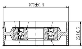
Ролик приводного ремня для автомобилей ГАЗон Next/ПАЗ/ЛиАЗ 4292 (дв. ЯМЗ 534) (только ролик натяжителя)
