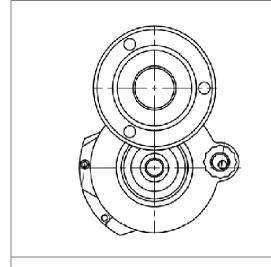
Ролик приводного ремня для автомобилей KAMA3 5490/Axor [OM457] с натяжным механизмом (генератора) d=78mm
